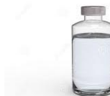
Fig. 2. Prepared DES (ChCl:AA ; 1:2 mole ratio)
